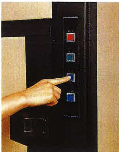
②ドアを閉め、下降ボタンを押します。 ①②を繰り返し、設定高、設定圧を感知した時、完了ランプが点灯します。
