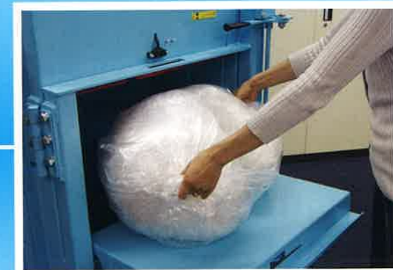
投入しやすい大型投入口。 (W610×H360mm)
