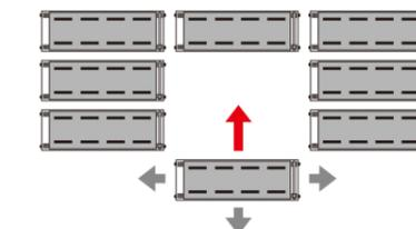
側面のスライドペダルを踏み込むと、センターの固定車が自在車に変換し、側面方向にも動かすことができるため、車輪の間など、任意の位置に移動することができます。
